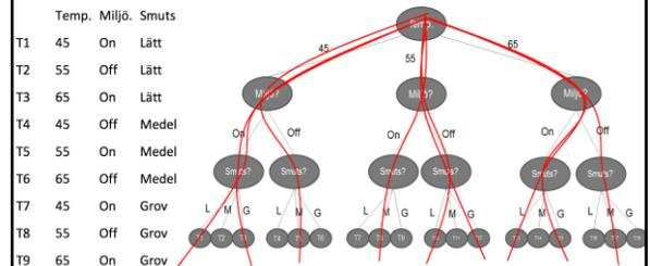
→ 9 testfall räcker för att testa alla parameterpar
